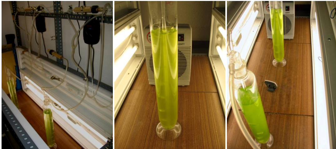
Figura 5- Incubador e montagem utilizada no crescimento das microalgas.
