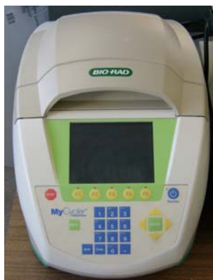
Figura 10 – Termociclador ( MyCycler – Bio-Rad ) usado na transcrição in vitro e no PCR.
