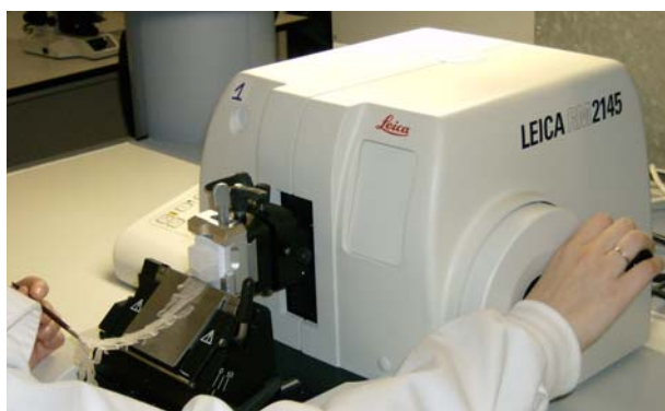
Figura 13 – Obtenção dos cortes do tecido no bloco de parafina usando o micrótomo ( Leica RM 2145 ).
