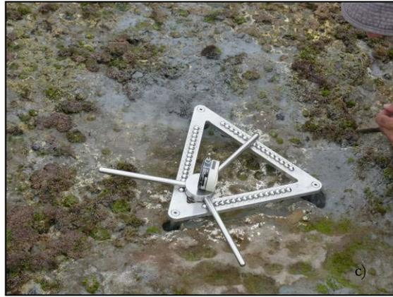
Fig. 3.5: a) Desenho detalhado do TMEM utilizado, A – plataforma metálica, B – suporte do comparador; b) comparador Sylvac; Adpatado de Neves, *et al.*, 2001. c) pormenor do TMEM utilizado em campo, fotografia de 22 de Julho de 2009.
