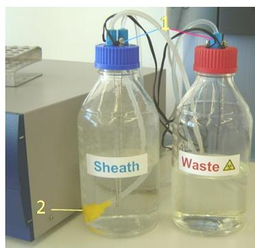
**Figura 8.** Recipientes do sistema hidrodinâmico (*Sheath*) e do esgoto líquido (*Waste*).
