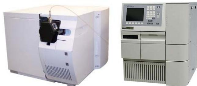
**Figura 5.6** – Cromatógrafo líquido (Waters) e espectrómetro de massa (Esquire 3000 Bruker).
