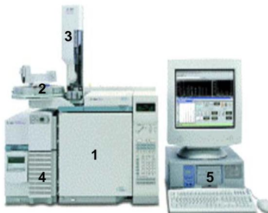
**Figura 5.4** – Cromatógrafo gasoso acoplado ao espectrómetro de massa, Agilent Technologies. Legenda: 1 – cromatógrafo gasoso; 2 – amostrador automático; 3 – torre de injeção; 4 – detector selectivo de massa; 5 – computador com “software”.
