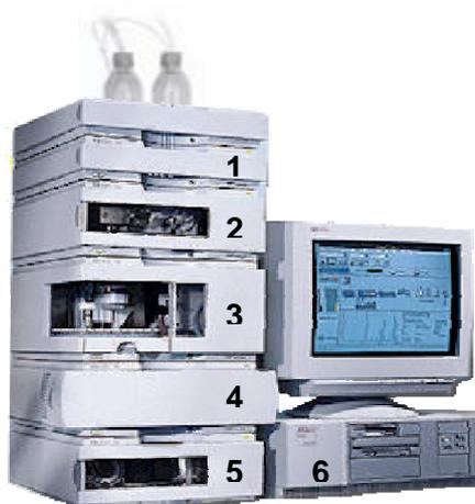
**Figura 5.5** – Cromatógrafo líquido Agilent 1100 Series (Agilent Technologies). Legenda: 1 – desgaseificador; 2 – bomba quaternária; 3 – amostrador automático; 4 – coluna e termostato; 5 – detector de rede de díodos; 6 – computador com “software.”
