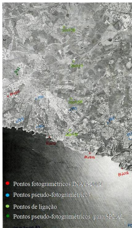
Figura 35: Distribuição de pontos incluídos na aerotriangulação, numa imagem da cobertura IGP-2007.
