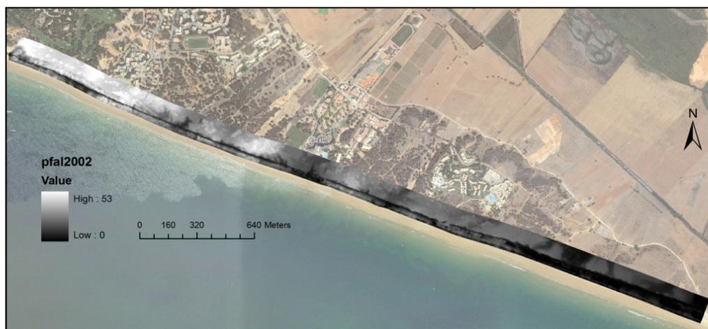
Figura 81: Modelo digital de terreno de 2002, na zona da Praia da Falésia.
