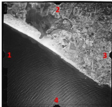
Figura 42: Definição da identificação e medição das marcas fiduciais.
