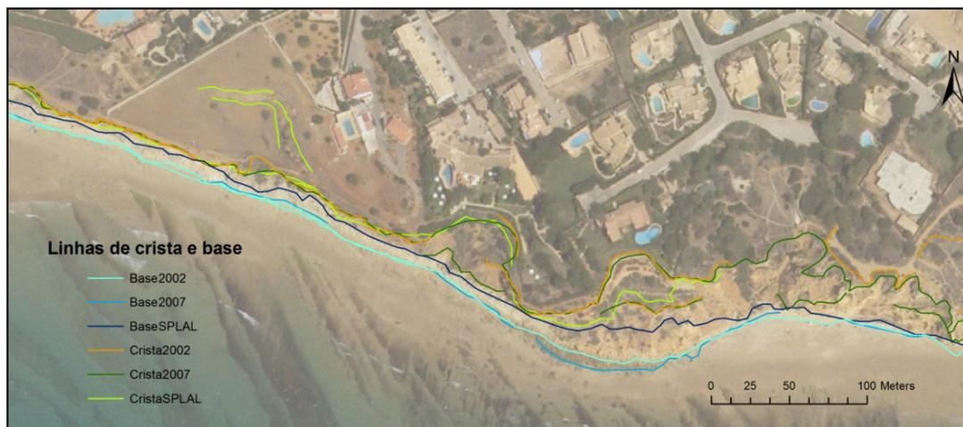
Figura 79: Pormenor das linhas de crista e base obtidas por estereorrestituição. Exemplo da Praia de Porto de Mós e do Canavial (Lagos).
