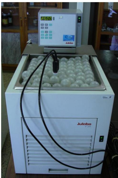
Figura VI.14: Banho termostático Julabo do novo sistema condutimétrico.
