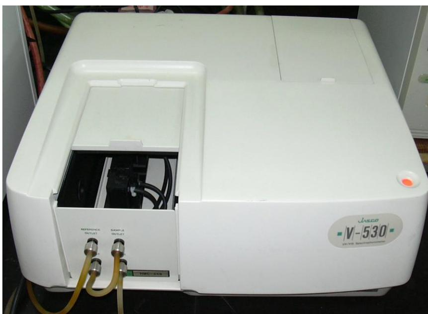
Figura VI.7: Espectrofotómetro Jasco-V-530 com módulo de termostatização.
