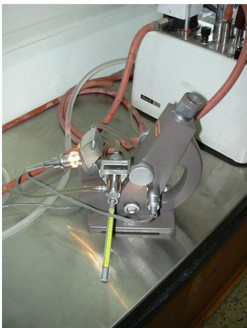
Figura VI.3: Pormenor do refractómetro.
