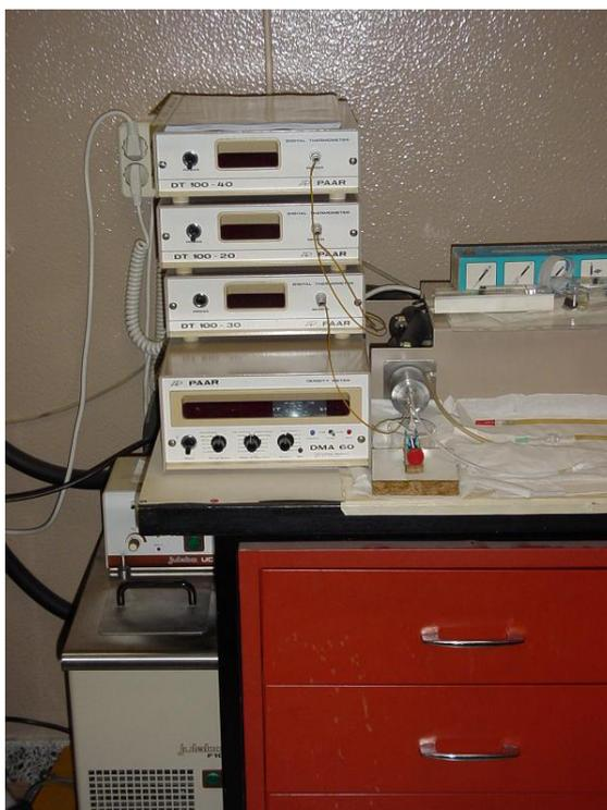
Figura VI.1: Densímetro utilizado, com as várias unidades e o banho de termostatização.
