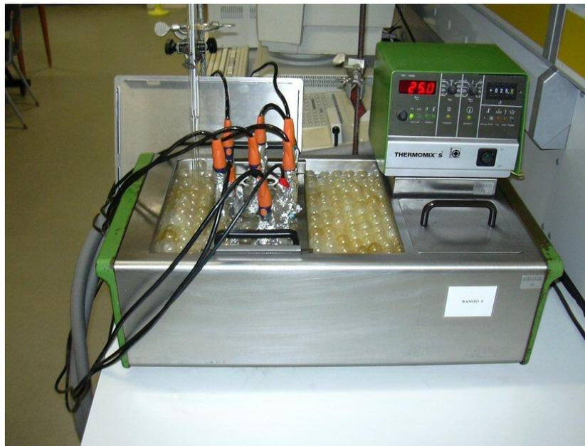
Figura VI.9: Banho termostático, cabeça termostática, suporte e células condutimétricas.
