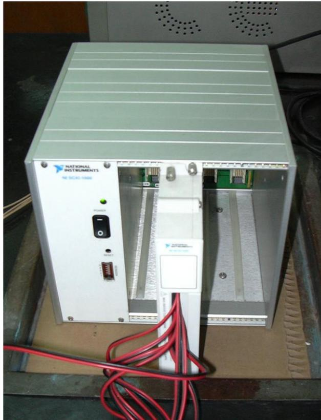
Figura VI.15: Módulo de comutação da National Instruments.
