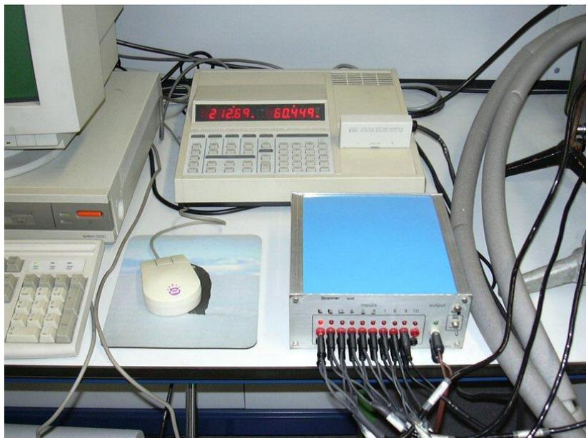
Figura VI.11: Elementos de leitura: caixa de comutação (em primeiro plano) e medidor LCR digital (em segundo plano).
