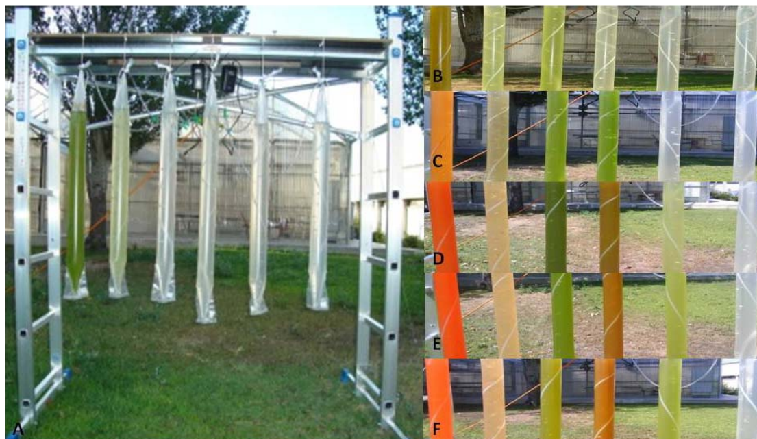
Figura 9: Estrutura montada outdoors para se efectuar a terceira fase de culturas de B. braunii (as fotos foram tiradas, A, 12 dias, B, 20 dias, C, 28 dias, D, 36 dias e E, 44 dias, F, 52 dias após o início das culturas)
