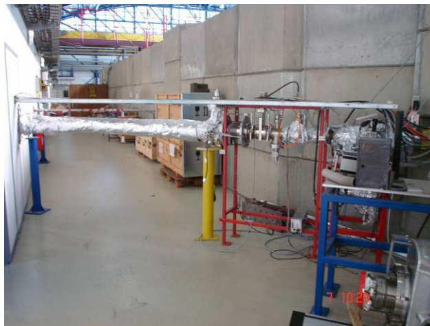
Figura 126 – Saída para uma linha de trabalho no sincrotrão em Dortmund.
