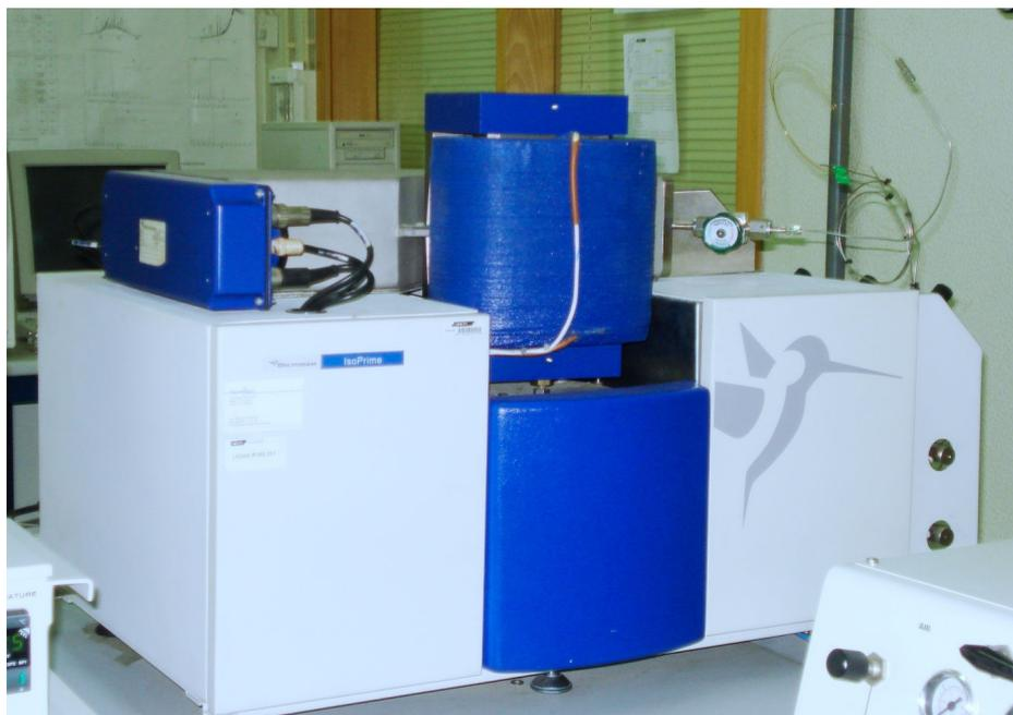
**Figura 5.1:** Espectrómetro de massa de razões isotópicas da marca Micromass, modelo Isoprime™.
