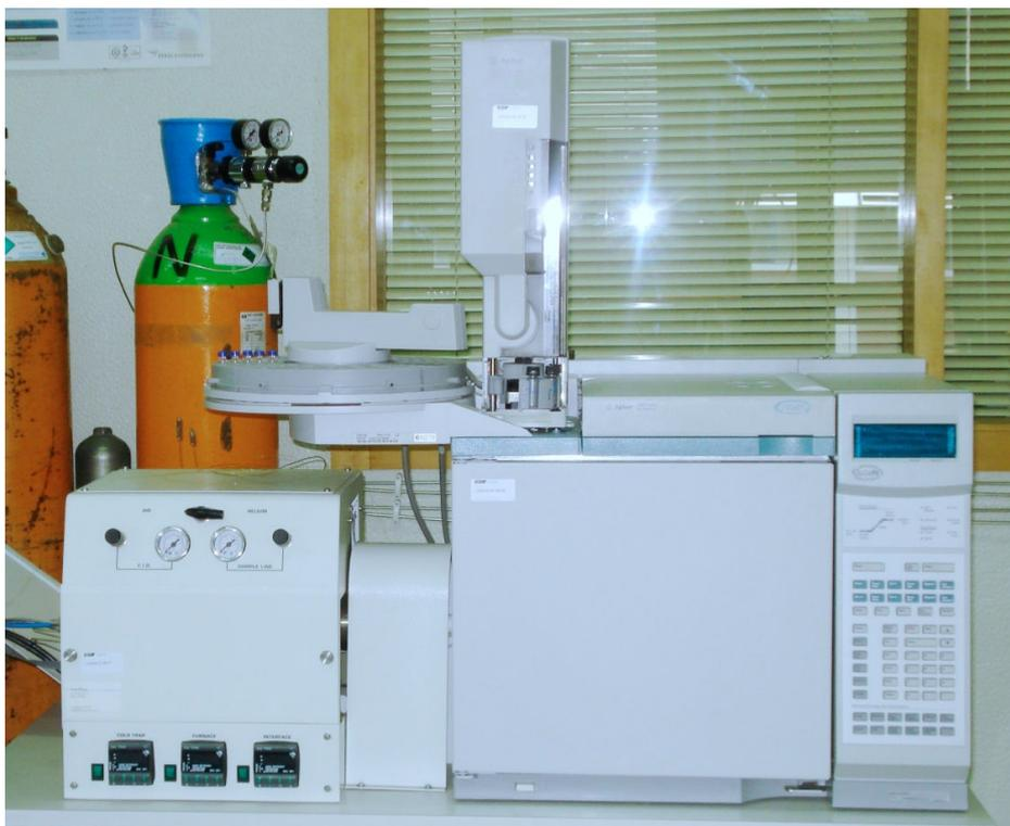
**Figura 5.4:** Cromatógrafo em fase gasosa da marca Agilent e interface de combustão hifenado ao Isoprime<sup>TM</sup>.
