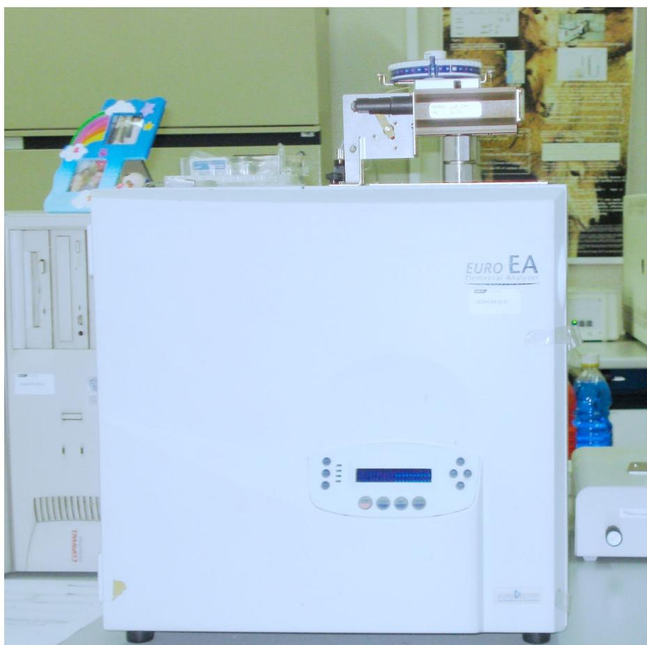
**Figura 5.3:** Analisador elementar da marca EuroVector, modelo Euro EA.
