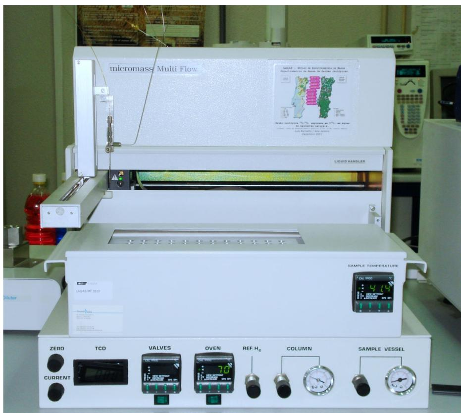
**Figura 3.10:** Equipamento para determinação da razão isotópica  $^{18}\text{O}/^{16}\text{O}$  pelo método de Equilíbrio com  $\text{CO}_2$  (equipamento em uso no INETI/LAQAS).
