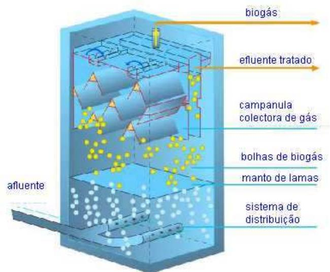
**Fig. 1.2** – Esquema representativo de um reactor UASB, adaptado do modelo BIOPAO® UASB
