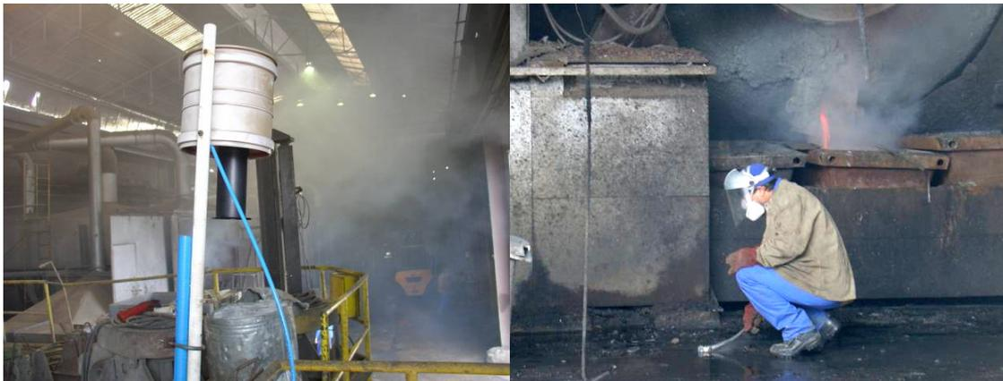
**Figura 3.3:** Unidade de filtros em cascata (SFU) e impactador colocados no piso 1 da fábrica (esquerda); Trabalhador junto a um dos fornos (direita).
