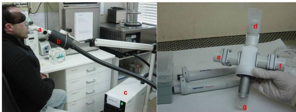
**Figura 3.1:** Equipamento EcoScreen completo, durante uma recolha de EBC (*esquerda*); Pormenor do sistema de válvulas unidireccionais (*direita*); a) sistema de válvulas unidireccionais; b) câmara de recolha arrefecida; c) sistema de refrigeração; d) bocal descartável; e) válvula unidireccional de inspiração; f) válvula unidireccional de expiração; g) tubo de recolha.
