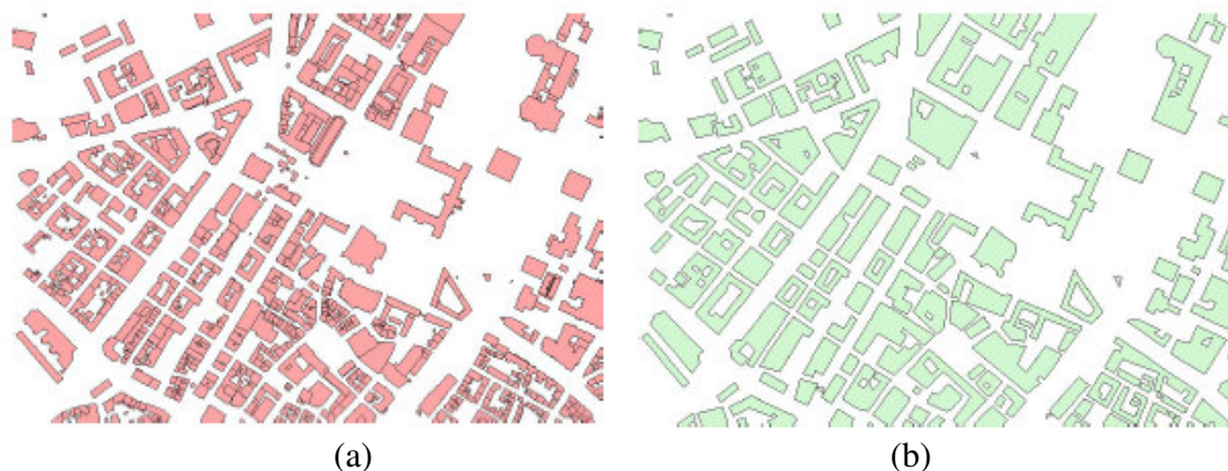
Figura 2.14 Generalização de Informação. (b) mostra uma generalização e simplificação da informação do mapa apresentado em (a) [Brenner05]
