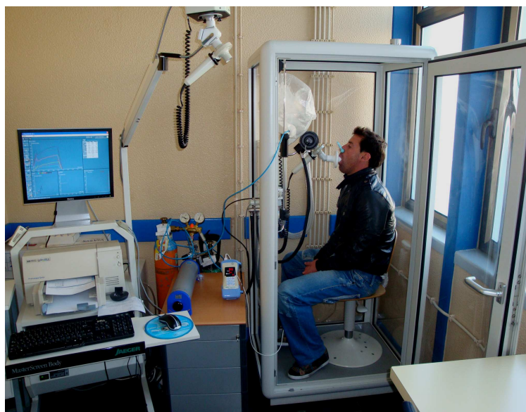
Figura 11 – Pletismógrafo com a funcionalidade de realizar o estudo do drive respiratório com CO 2
