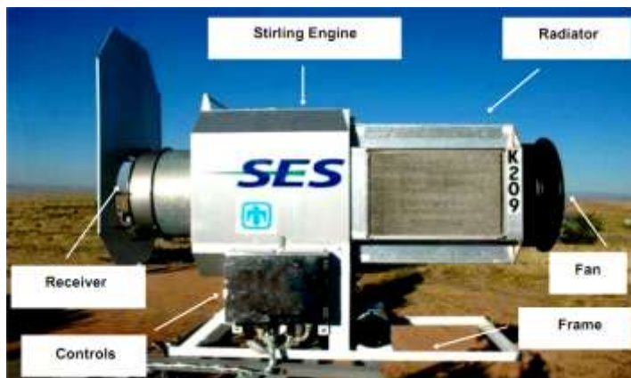
Figura N° 3.21. Unidad de conversión de potencia.
