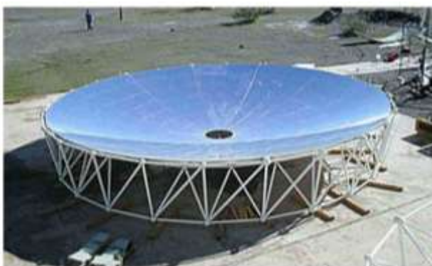
Figura N° 3.19. Concentrador de 8'5 metros de diámetro de SBP.
