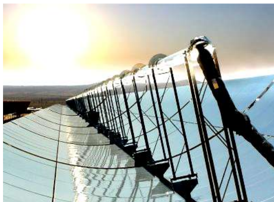
Figura N° 3.8. Captación solar por espejos Cilindro-parabólicos
