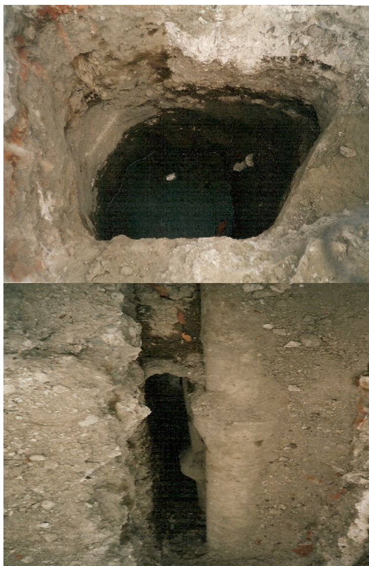
Foto 5.5 y 5.6.- Excavaciones para observación de la contaminación en lugar donde se extrajo las muestras.
