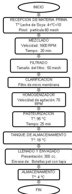
**Figura 8. Diagrama de flujo del proceso de elaboración de Leche de Soya con Pinol**
