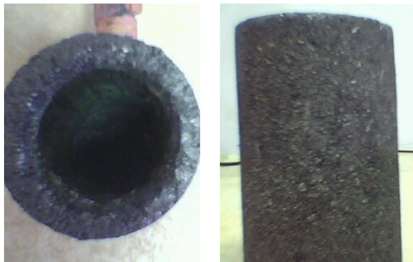
FIGURA 2.5. FISURAS EN EL MICROHORNO LUEGO DE 17 FUSIONES
