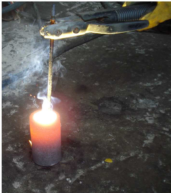
FIGURA 2.7. PRIMER ENSAYO DEL MICROHORNO DE FUSIÓN
