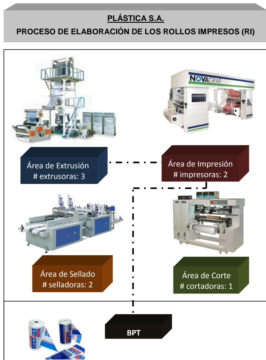
Gráfico 3.2. Descripción del Proceso de Elaboración de los Rollos Impresos
