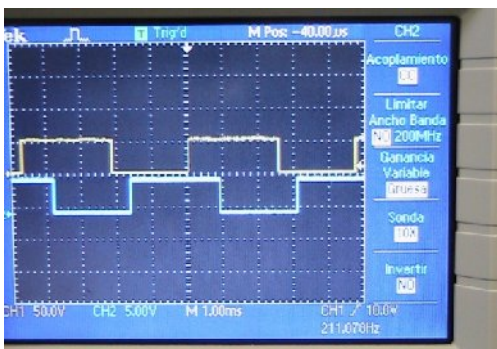
Figura 13. PWM al 100% del microcontrolador
