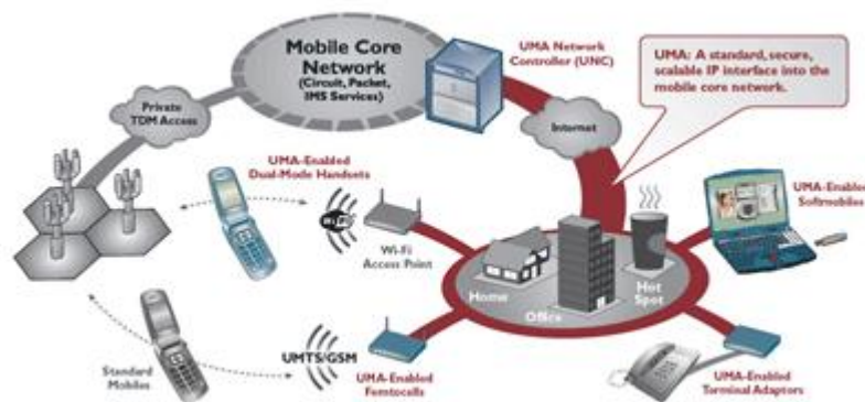
Figura 3.2: Infraestructura de la tecnología UMA
