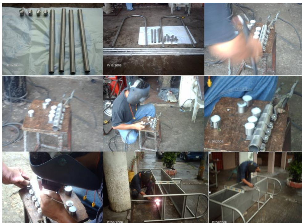
FIGURA 2.2. PROCESO DE CONSTRUCCIÓN DEL BANCO EXPERIMENTAL
