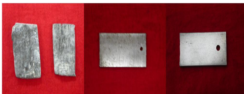
Figura 3.3: a) ÁNODO DE ZINC. b) PROBETA SIN RECUBRIMIENTO. c) PROBETA CON RECUBRIMIENTO.
