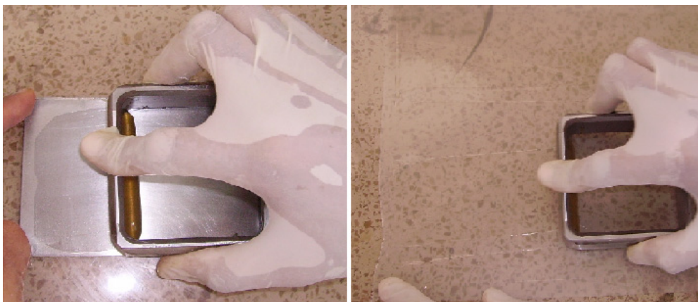
FIGURA 3.21. APLICACIÓN DE LAS MEZCLAS SOBRE PLACA DE ACERO Y SOBRE LÁMINA DE POLIETILENO.
