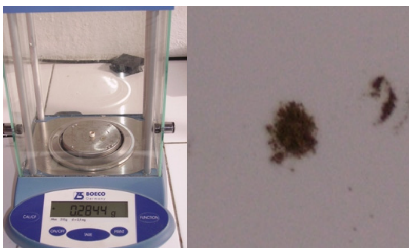
FIGURA 3.24. A LA IZQUIERDA MUESTRA PESADA PREVIO A ENSAYO. A LA DERECHA MUESTRA CARBONIZADA AL FINAL DEL ENSAYO
