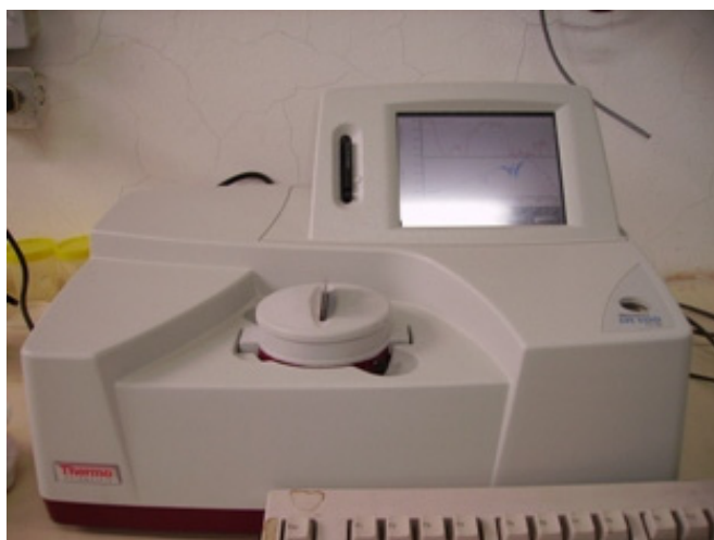
FIGURA 3.25. EQUIPO THERMO SCIENTIFIC NICOLET IR100
