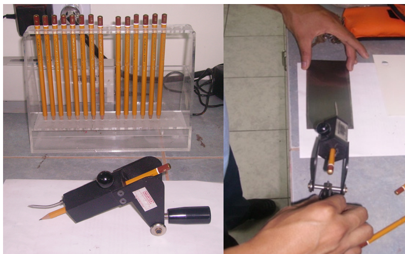
FIGURA 3.31. PRUEBA DE DUREZA AL LÁPIZ INEN 1001.
