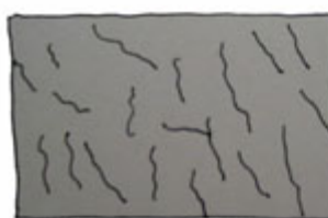
fisuras en la losa por retracción plástica del hormigón
