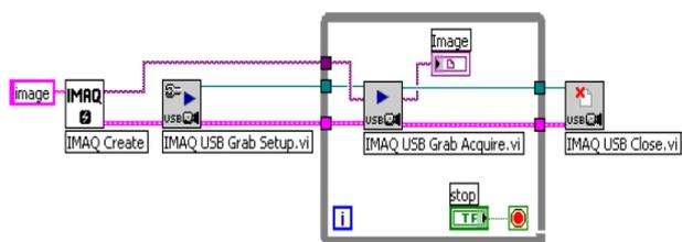
Figura 3. Ejemplo de cómo obtener una imagen usando iconos de NI – IMAQ para Cámaras USB
