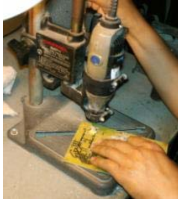
Fig. 20: Taladrado de agujeros para los componentes
