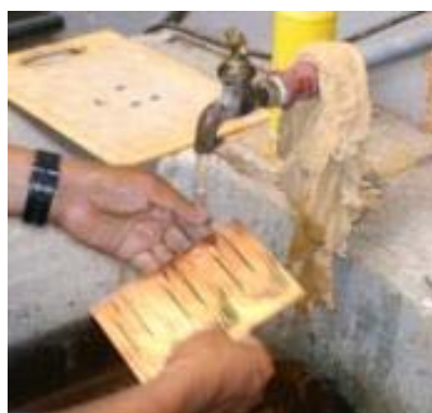
Fig. 16: Limpieza de restos del revelador
