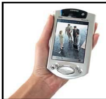
Figura 2.8 Con una PDA y tecnología WLAN se pueden visualizar las imágenes de las cámaras IP.
