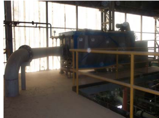
Figura # 9: Tambor Desaguador "Trommel" de Nielsen & Hieber de Suecia
