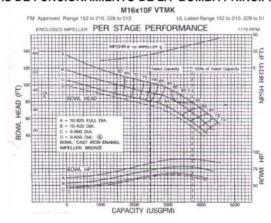
Luego se escogió el diámetro del impeler en base a los características mencionadas anteriormente y la eficiencia de la bomba.
