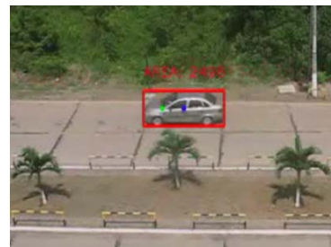
Figura 4. Vehículo dentro de la caja englobante con la predicción de la siguiente posición (punto color verde), punto azul representa al centroide.
