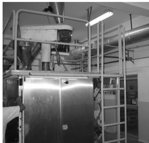
**Figura 12.** Plataforma, escalera y baranda de seguridad de envase de bebidas de chocolate.
