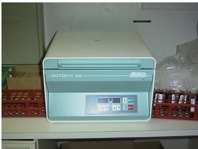
Kuva 5. Hettich Rotofix 32 sentrifugiin menevien putkien teline on kuvassa fugin oikealla ja ulostulevien teline odottaa vasemmalla puolella.
