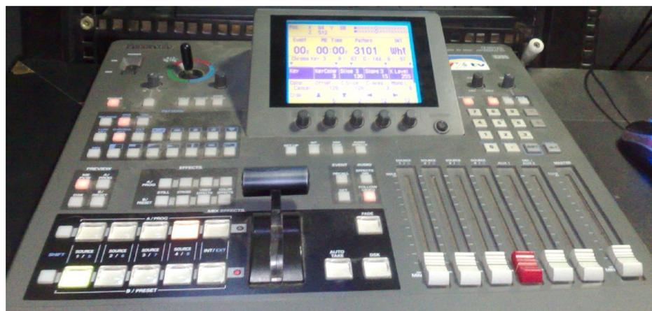
penulis memulai dengan cara menghidupkan *Mixer Panasonic MX-70* kemudian menghidupkan *CCU(Camera Control Unit)*, lalu penulis melakukan *setup* pada *mixer* dengan menentukan *input 1* pada *mixer* yang
