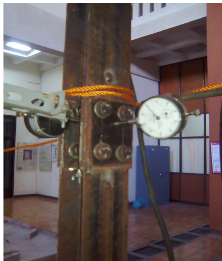
Gambar 3.12 Gambar Benda Uji Sambungan Pada Sayap
