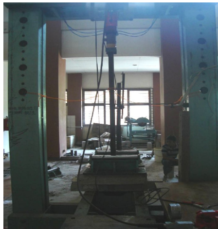
Gambar 3.1 Loading Frame dan Hydraulic Jack
