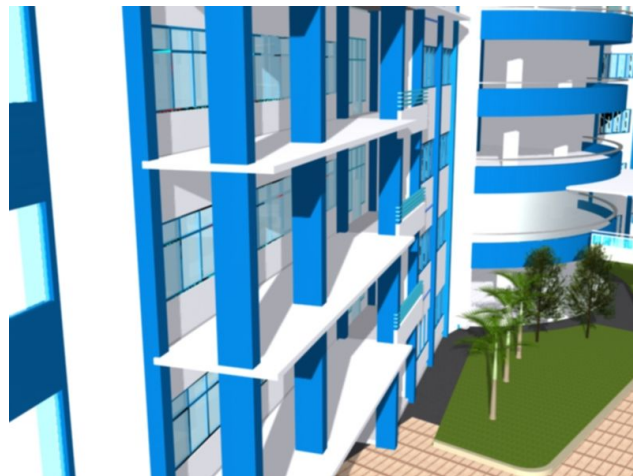
Gambar.5.9 Strategi desain penggunaan sirip untuk mereduksi radiasi matahari (sumber. Sketsa pribadi)
