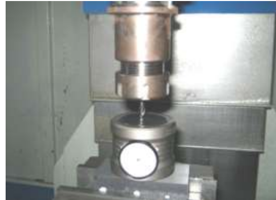
Gambar 10. Proses Menentukan Titik 0 Sumbu Z
