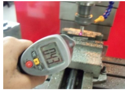
Gambar 17. Pengukuran Suhu Cutter dengan Infrared Thermometer
