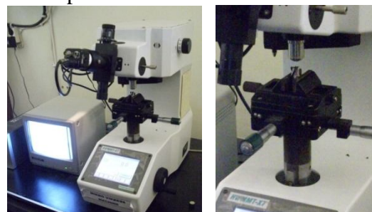
Gambar 24. Pengukuran Keausan Tepi Cutter End Mill
