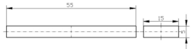
Gambar 9. Spesimen 2 Tanpa Las (*Raw Material*)
