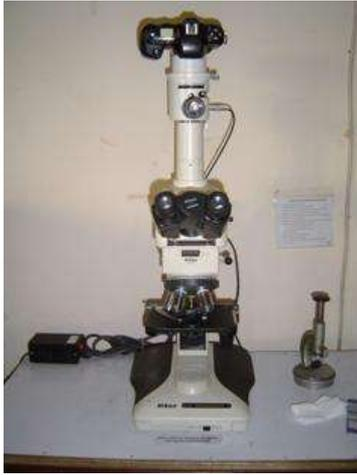
Gambar 4. Alat Uji Metalografi
