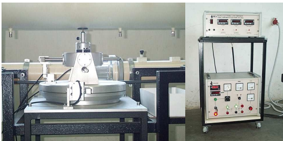
Gambar 8. Strain gages balance dan modul pengukuran gaya.
