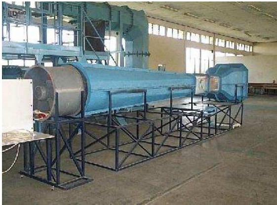
Gambar 7. Open loop aerodynamic tunnel yang digunakan dan seksi ujinya.
