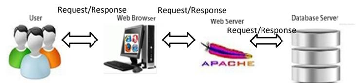
Dari desain sistem di atas terlihat bahwa user melalui web browser meminta informasi atau melakukan inputan/transaksi pada aplikasi yang terdapat pada web server, web server akan melayani permintaan tersebut dengan mengambil/menginputkan data-data pada database dan akan mengirimkan balasan berupa informasi yang diminta.
