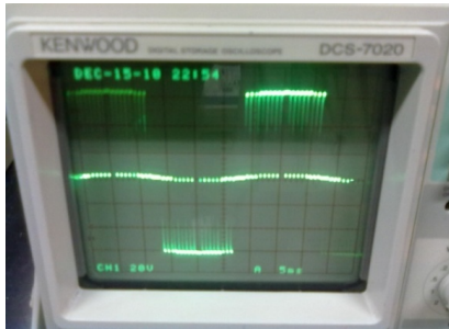
Gambar 12. Gelombang tegangan keluaran SPWM inverter
