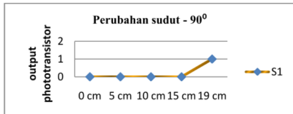
Gambar 21. Pengujian sudut -90° antara robot leader dan robot follower.
