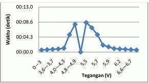
**Gambar 7.** Grafik Kecepatan Gerak *Linear Drive Cylinder* X Berdasarkan Tegangan Referensi *Proportional Valve X*
