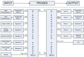
Gambar 4. Pemanfaatan Port Mikrokontroler ATMega16L pada Komponen Hardware
