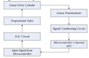
Gambar 8. Diagram Sistem Kerja Silinder
