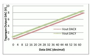
**Gambar 11.** Grafik Tegangan Referensi Hasil Pengukuran pada Rangkaian DACX dan DACY
