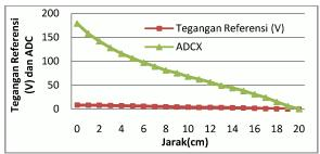
**Gambar 9.** Grafik ADC dan Tegangan Referensi Setiap Perubahan Jarak Per 1cm pada *Linear Potentiometer* X
