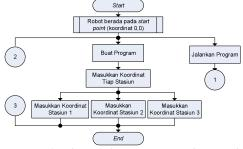
Gambar 5. Flowchart Pembuatan Program Robot Cartesian
