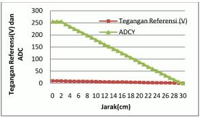
Gambar 10. Grafik ADC dan Tegangan Referensi Setiap Perubahan Jarak Per 1cm pada *Linear Potentiometer* Y
