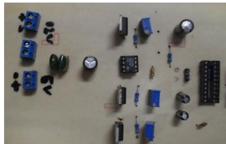
Gambar 3.4 Rangkaian Pembacaan Sensor RTD
