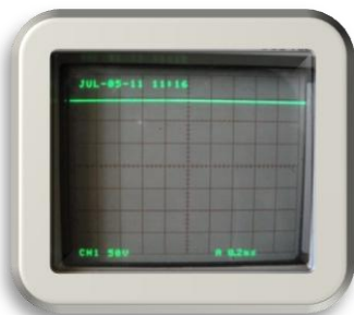
Gambar 3.3 Tegangan keluaran ketika Tegangan Masukan 100 Vac
