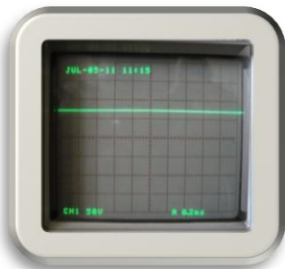
Gambar 3.2 Tegangan keluaran ketika Tegangan Masukan 50 Vac
