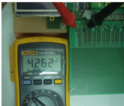
Gambar 8 Cek Output pada pin VCC
