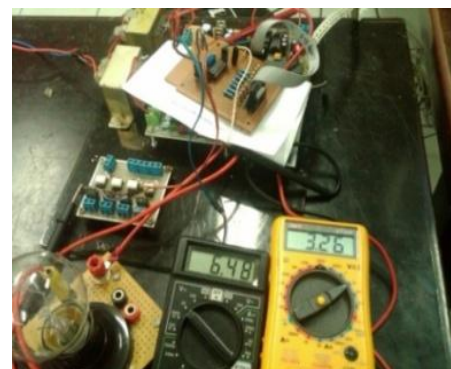
Gambar 14. pengujian rangkaian DAC R/2R
