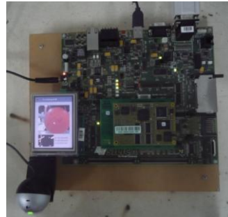
Gambar 8. Sistem penjejak bola phyCORE-i.MX31
