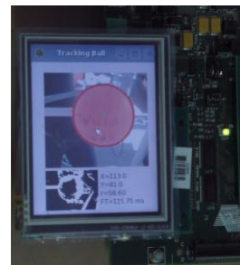
Gambar 9. Hasil pengujian awal (bola terdeteksi dan dapat menampilkan titik tengah bola)
