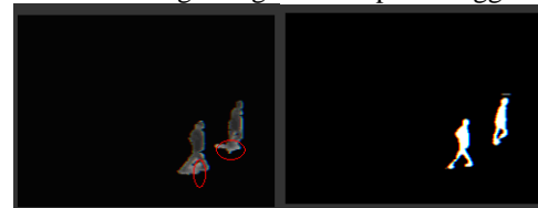
Gambar 9. sebelum dan sesudah proses thresholding
