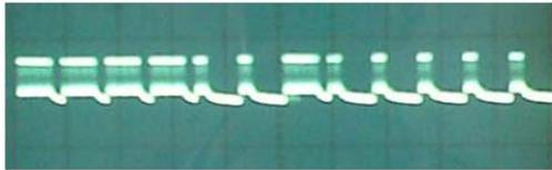
Gambar 4. Bentuk sinyal remote transmitter tombol nomor 1
