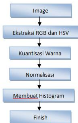
Gambar 2: Diagram Blok Ekstraksi Warna
